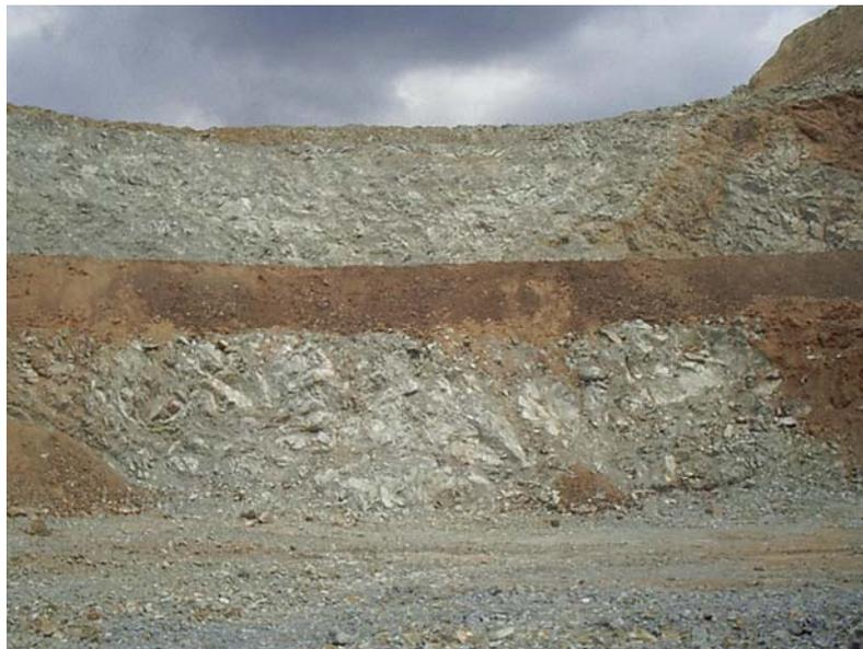
Figura 2. 17 (Fotografía) Cantera Calandaima, vista general de la explotación de roca ígnea intrusiva fresca (diorita).
