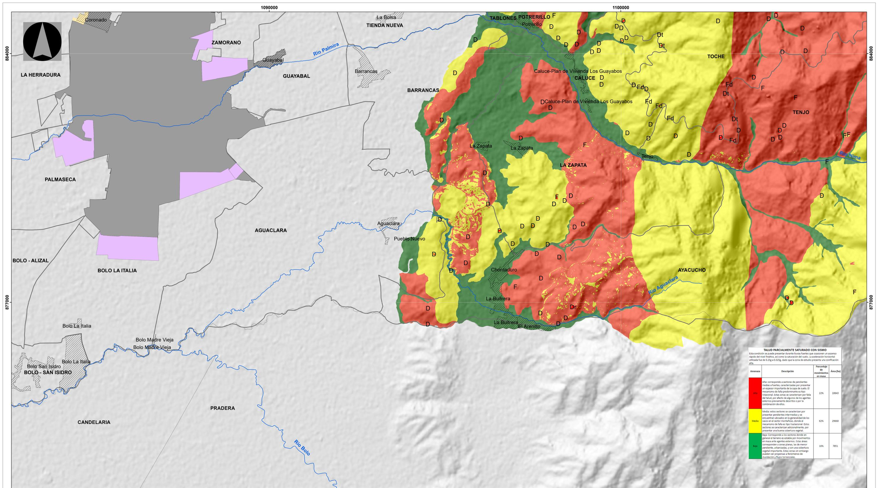
**TALUD PARCIALMENTE SATURADO CON SISMO**
