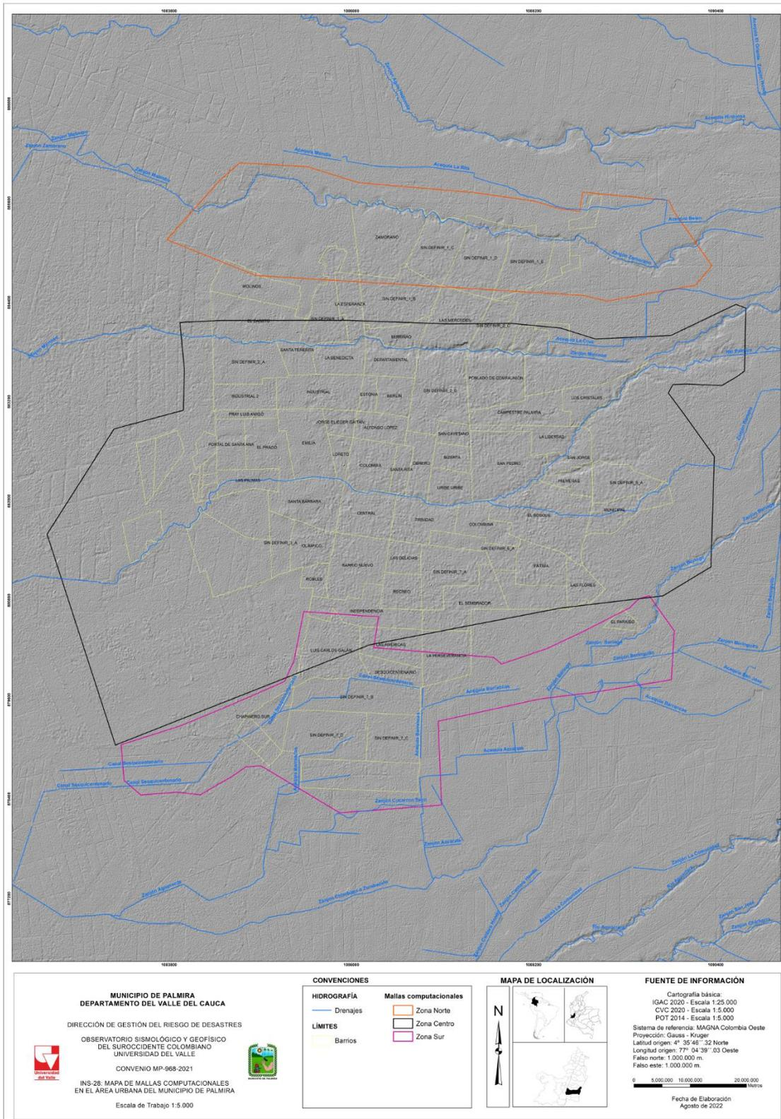
Figura 84. Grillas empleadas para las modelaciones hidráulicas área urbana y de expansión urbana del municipio de Palmira
