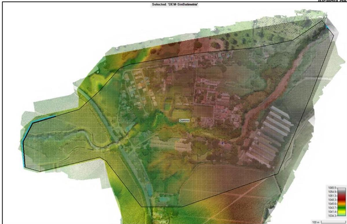
**Figura 8.** Configuración geométrica del modelo HEC-RAS para el análisis de inundaciones
