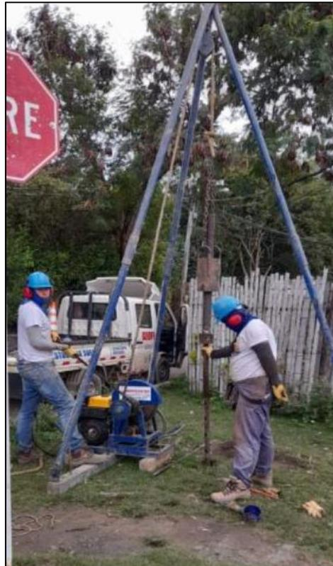
Figura 14. Montaje Equipo de Perforación SPT
