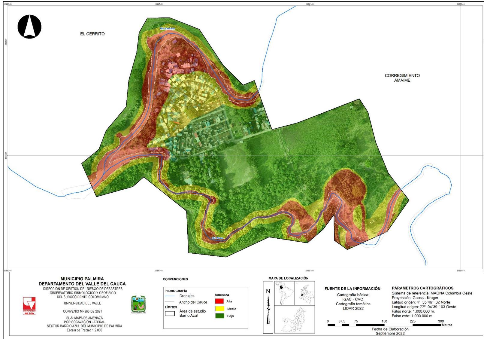
Figura 95. Amenaza por socavación lateral (SL-8)
