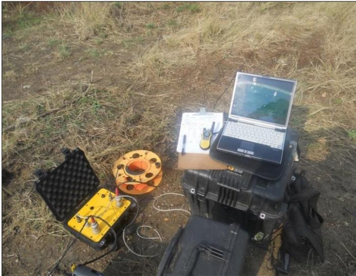
Figura 18 Sismógrafo Seistronix RAS-24.
