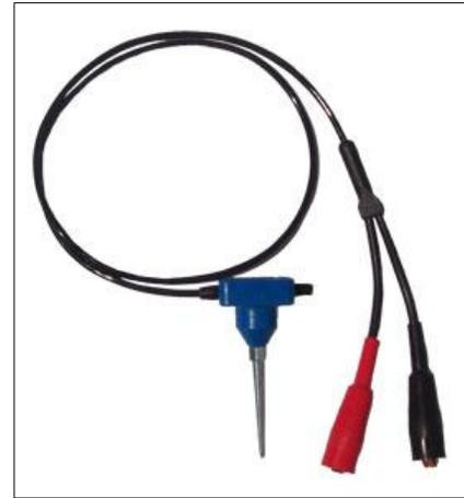
**Figura 17** Geófonos de adquisición de datos.
