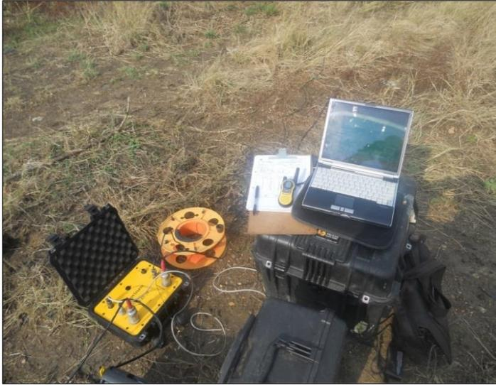
**Figura 16** Sismógrafo Seistronix RAS-24
