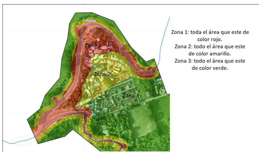
Figura 4. Zonas de exposición ante socavación lateral
