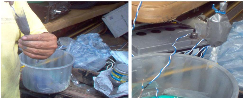
Figura 4.22 Proceso de fabricación de cargas explosivas para ensayo de refracción sísmica
