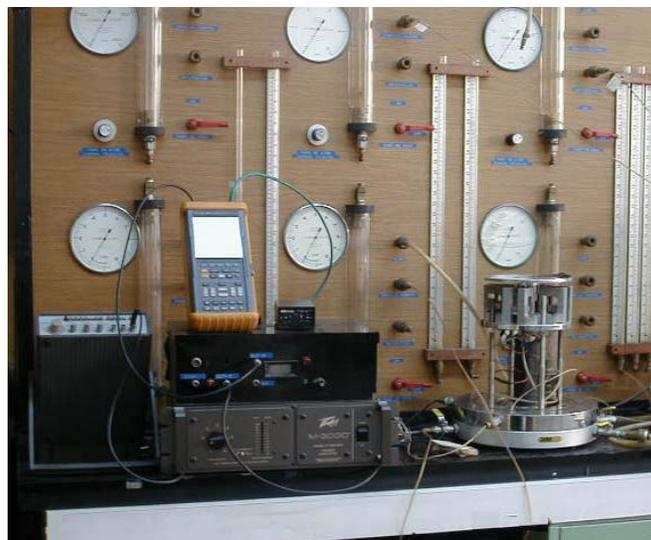
Figura 4.48 Montaje del ensayo de columna resonante
