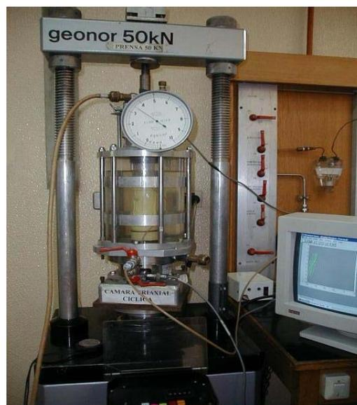
Figura 4.46 Montaje típico del ensayo triaxial cíclico
