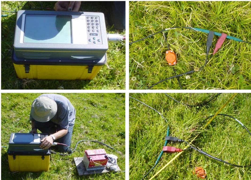
Figura 4.24 Componentes y montaje para el ensayo de refracción sísmica
