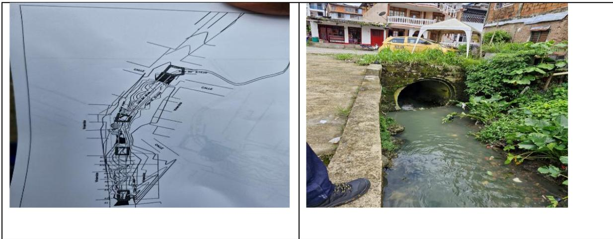
Plano de obra; estructura de entrada, cámaras especiales y descarga al box existente, obra que permite el paso de la quebrada que antes corría en tierra por la vía.
