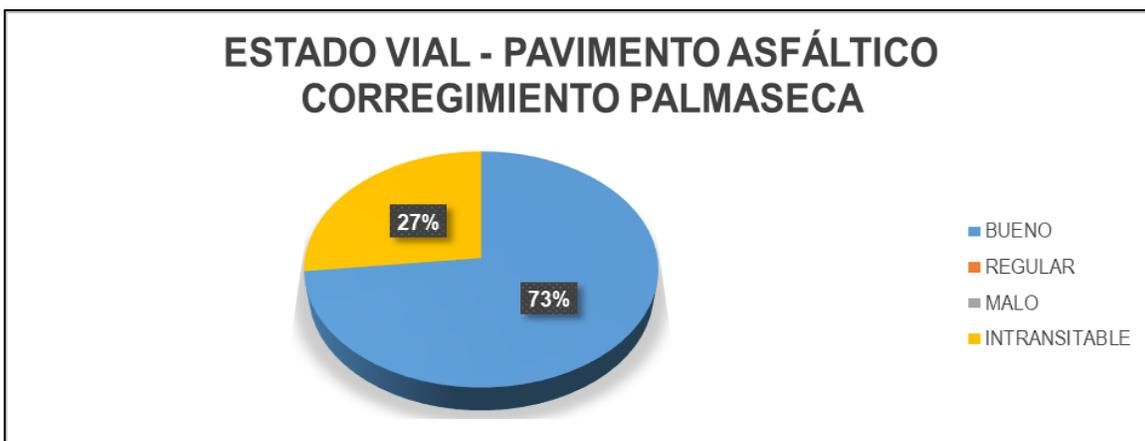
El estado superficial del pavimento asfáltico en el corregimiento de Palmaseca se encuentra bueno en un porcentaje de 73% y un estado intransitable del 27%.
