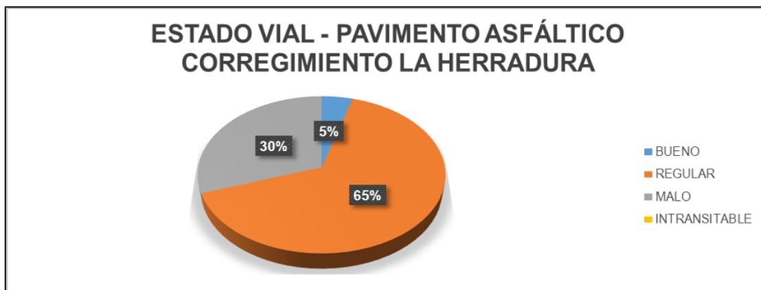
La grafica muestra que el pavimento asfáltico en el corregimiento de la Herradura se encuentra en estado regular el mayor porcentaje siendo el 65%, en estado malo el 30% y en estado bueno el 5%
